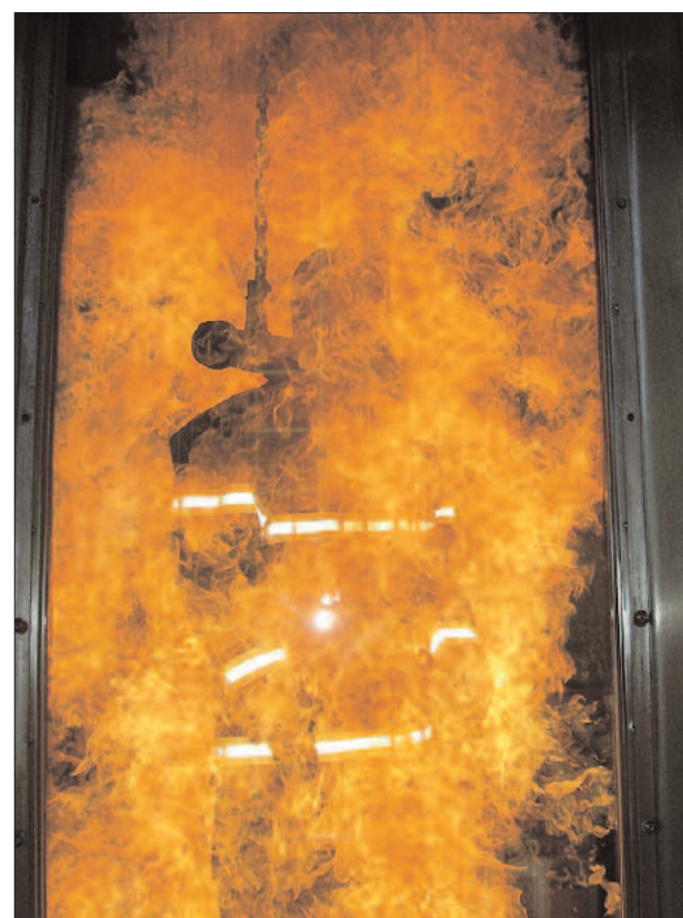
Un complet de pompieri manufacturat după tehnologia DuPont supus la grele încercări
